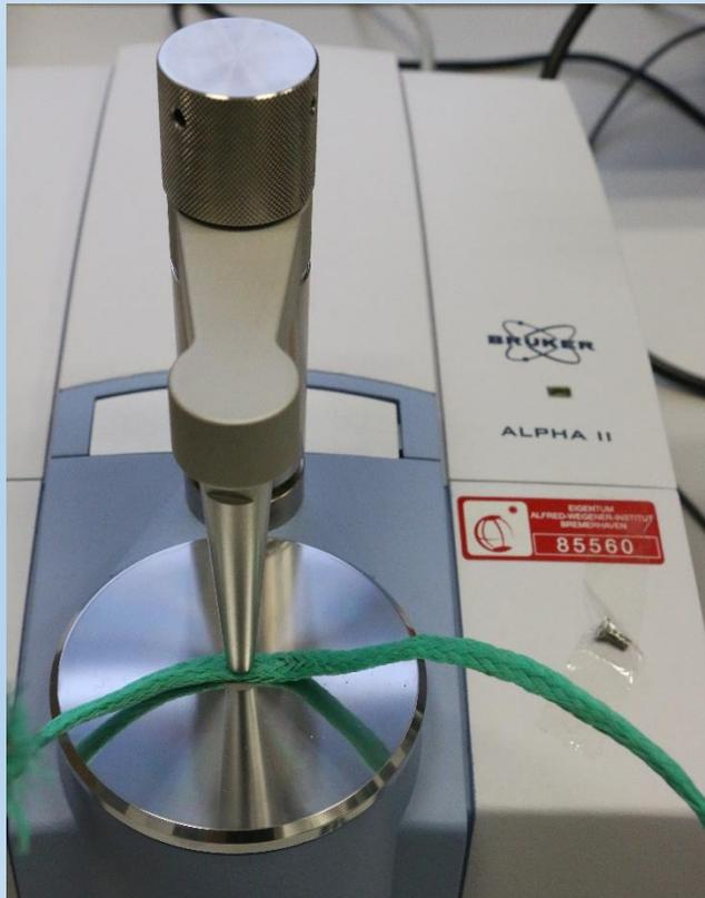
Jedes Plastikteil wird in das FTIR-Gerät geklemmt (hier ein Stück Seil), dann wird ein Spektogramm gemessen, mit dem dann anhand von einer Software entwickelt vom AWI der Plastiktyp bestimmt werden kann.
